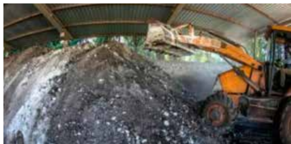
Aplicação de cal virgem no lodo de esgoto
